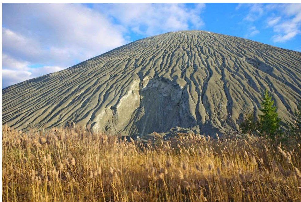
Photo 2 En amont du lac à la Truite, une grande superficie du bassin est occupée par les résidus miniers. Les dépôts miniers d'une forte pente et non stabilisés sont responsables d'un apport important de sédiments vers le réseau hydrographique. Photo de 2020.
