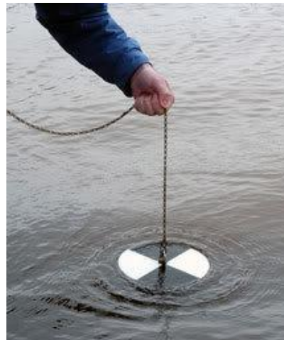
FIGURE 1 MESURE DE LA TRANSPARENCE DE L'EAU AVEC UN DISQUE DE SECCHI (ASSOCIATION DE LA PROTECTION DU LAC DES ÎLES)
